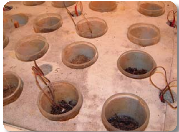
Figure 2. Carottes de sol placées dans un extracteur à fort gradient (photo par J. Addison).
